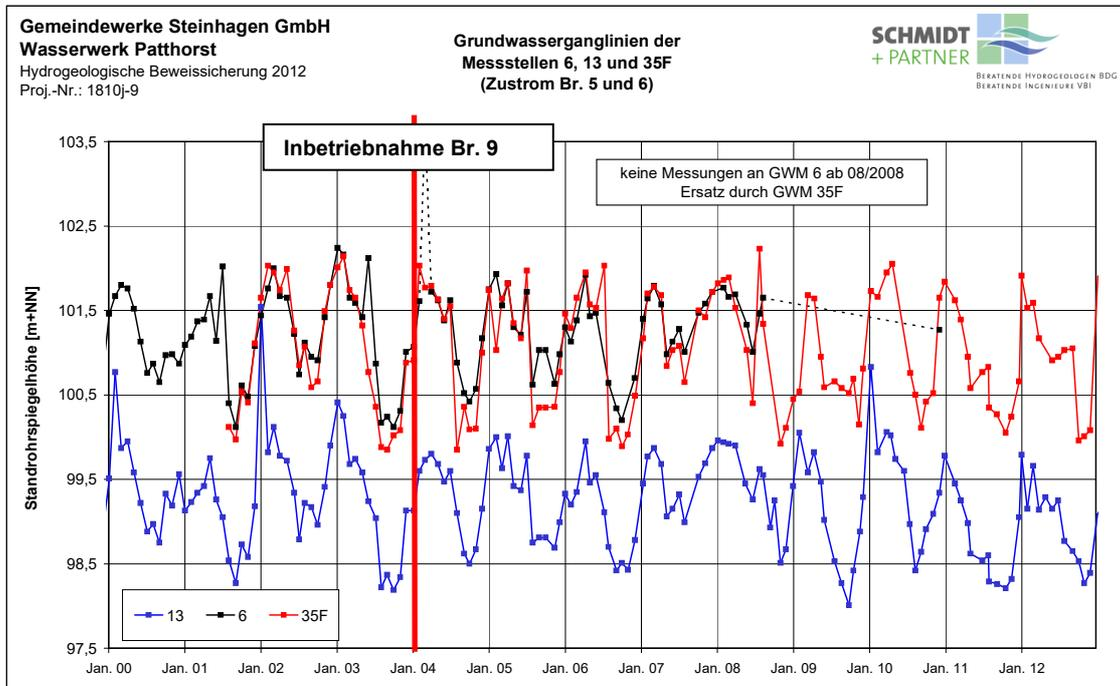
**Abb. 7:** Grundwasserstandsganglinien der GWM 6, 13 (bis 08/2008) und 35F (ab 08/2001) bei Beobachtungsfläche 1 von 2000 bis Dezember 2012 (Detaildarstellung aus Anh. 3).
