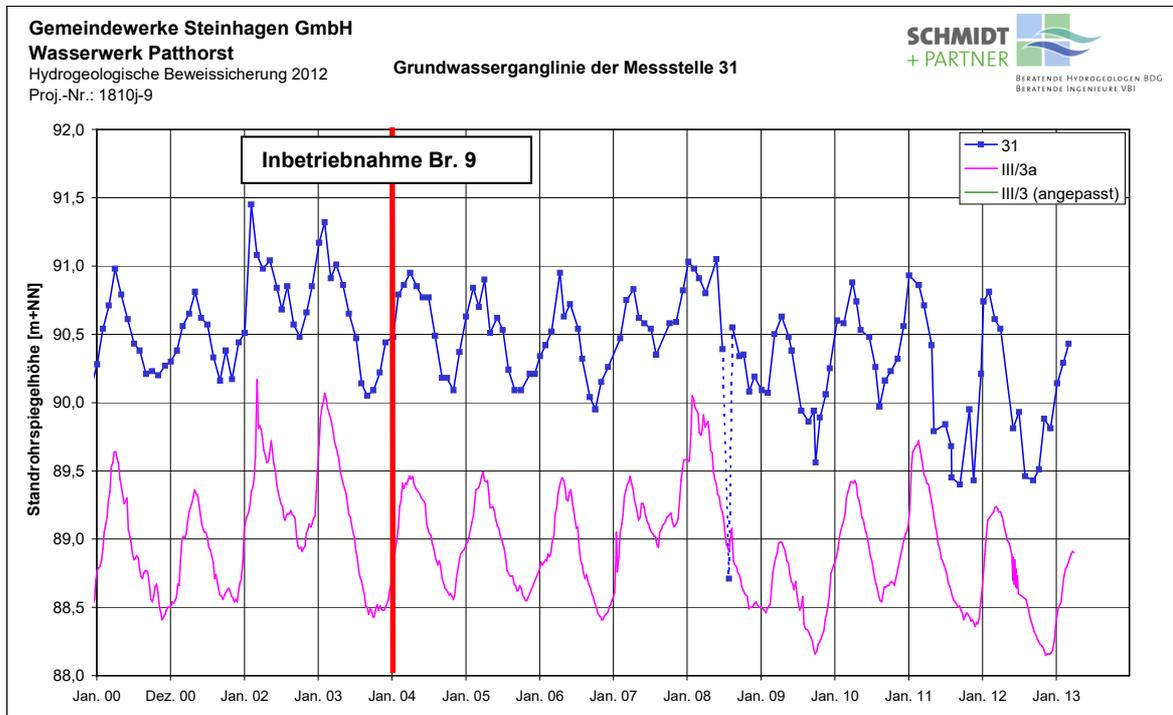
**Abb.11:** Grundwasserstandsganglinie der GWM 31 bei Beobachtungsfläche 5 und 5n sowie der Referenzmessstelle III/3 und III/3a für den Zeitraum ab 01/2000
