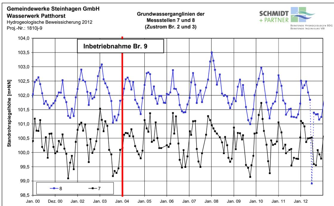
**Abb. 8:** Grundwasserstandsganglinien der GWM 7 und 8 bei Beobachtungsfläche 2 von 2000 bis Dezember 2012 (Detaildarstellung aus Anh. 3).
