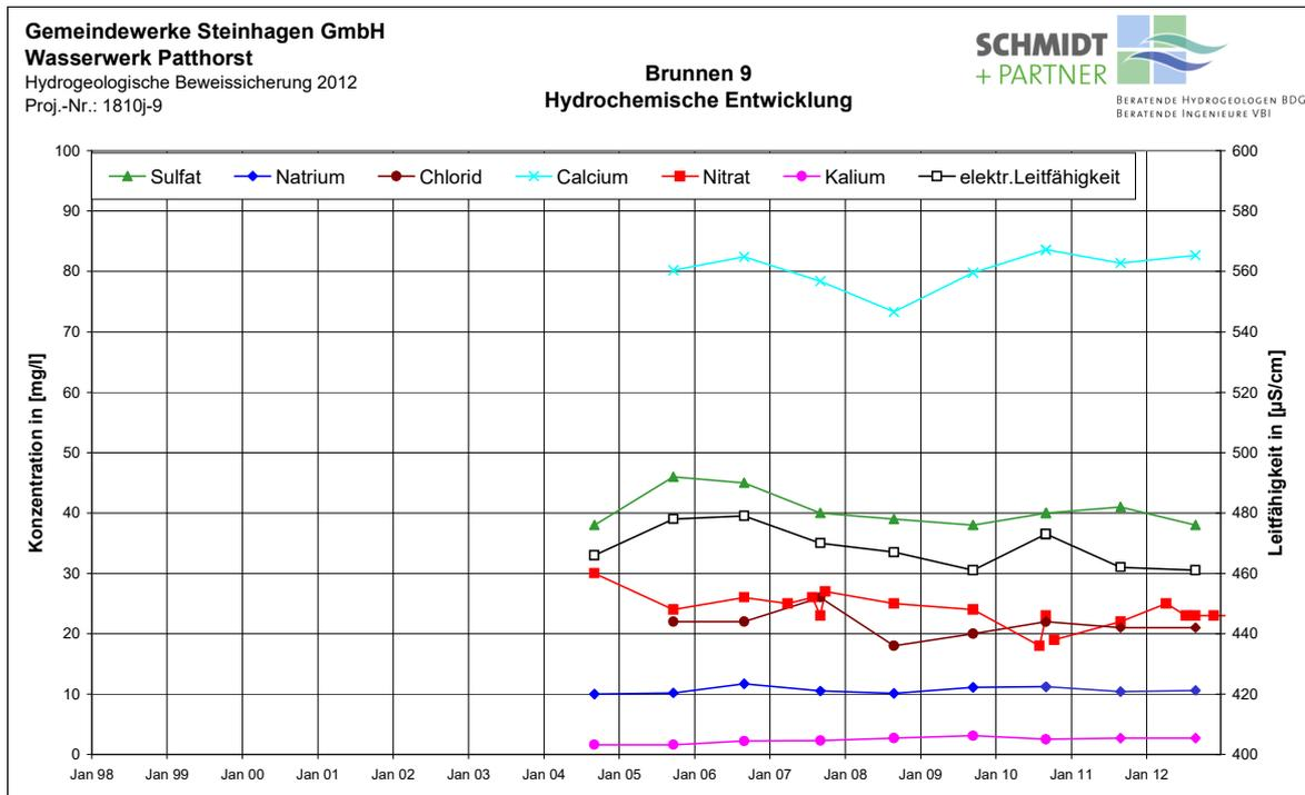
**Abb. 13: Entwicklung hydrochemischer Parameter an Brunnen 9 von 2004 bis 2012**
