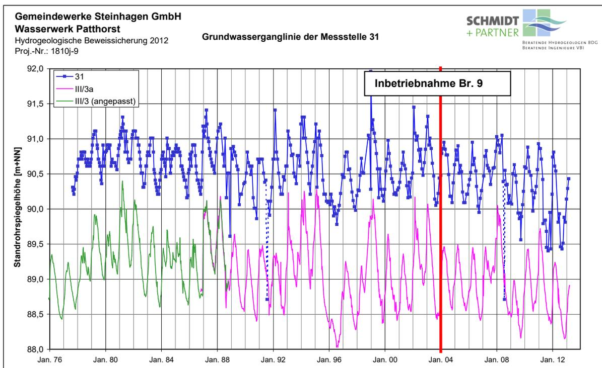
**Abb.10:** Grundwasserstandsganglinie der GWM 31 bei Beobachtungsfläche 5 und 5n sowie der Referenzmessstelle III/3 und III/3a
