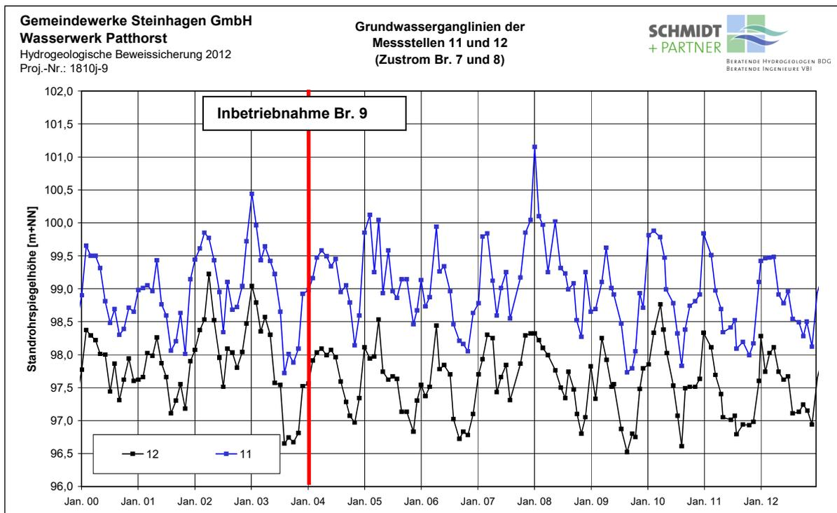
**Abb. 9:** Grundwasserstandsganglinien der GWM 11 und 12 bei Beobachtungsfläche 3n von 2000 bis Dezember 2012 (Detaildarstellung aus Anh. 3).
