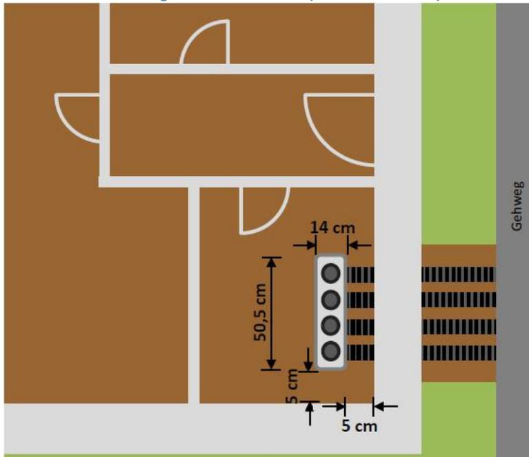
Die angegebenen Maße müssen bei fertigem Ausbau des Gebäudes eingehalten werden. Das bedeutet, der Abstand von 5 cm von Wand bis MSHE ist bei Endzustand (z.B. Putz) einzuhalten. Der Hausanschlussraum muss straßenseitig gelegen sein. Die **maximal** zulässige Schutzrohrlänge ist **3 m**.
